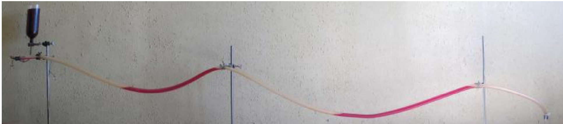
Рис.1. Модель трубопровода с нисходящими и восходящими участками.
